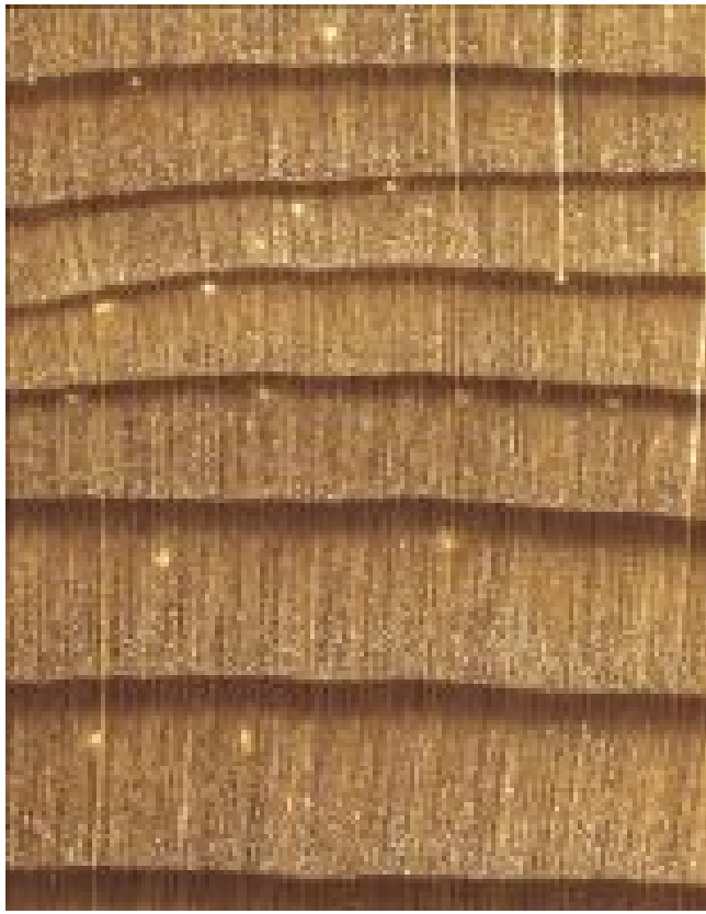
Lärche ( Larix sp.): Querschnitt (ca. 12x)
